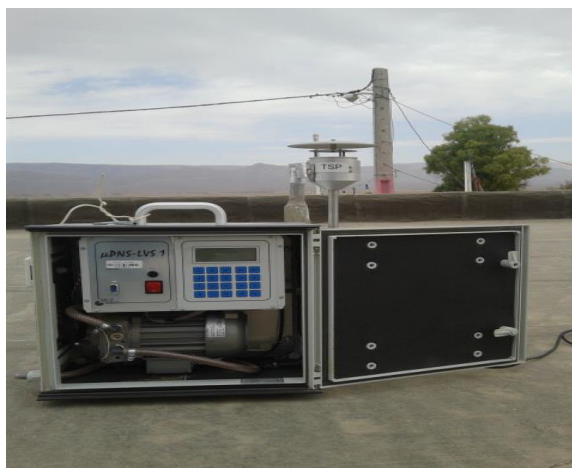
شکل ۴. دستگاه جمع‌آوری‌کننده گردوغبار میکروپنس نوع LVS 1 به همراه نمونه‌گیر آن در قسمت فوقانی
