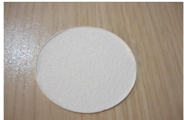
شکل ۶. نمونه‌ای از فیلتر کوارتز خالی از گردوغبار
