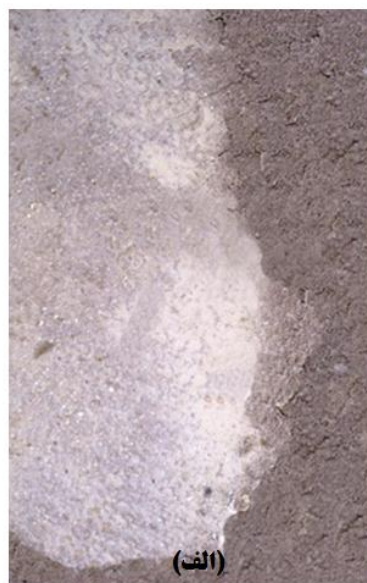
شکل ۴. پاشش و جاری ساختن آب به روی تیمارها، الف) مالچ AI (% خاک با بافت رسی، ۱۰٪ لجن کنور تور، ۵٪ پودرسنگ) و خاک با فرسایش متوسط، ب) مالچ پلیمری و خاک فرسایش شدید با سطح صاف و شیب‌دار.
