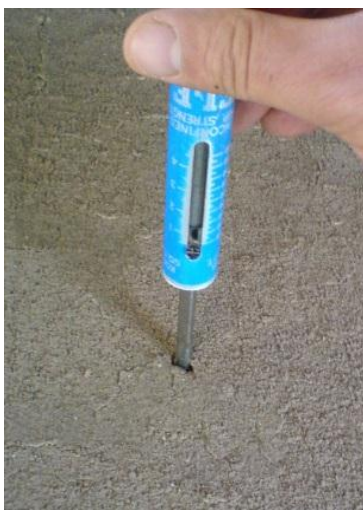
شکل ۳. انجام آزمایش مقاومت فشاری با استفاده از نفوذسنج جیبی
