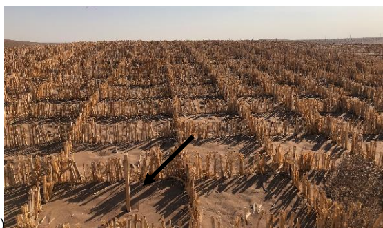
شکل ۳. نصب پیکه‌های چوبی جهت اندازه‌گیری ضریب اثر تثبیت‌کنندگی در تپه شاهد (الف) و در تپه پوشیده شده به وسیله بادشکن گیاه نی (ب)
