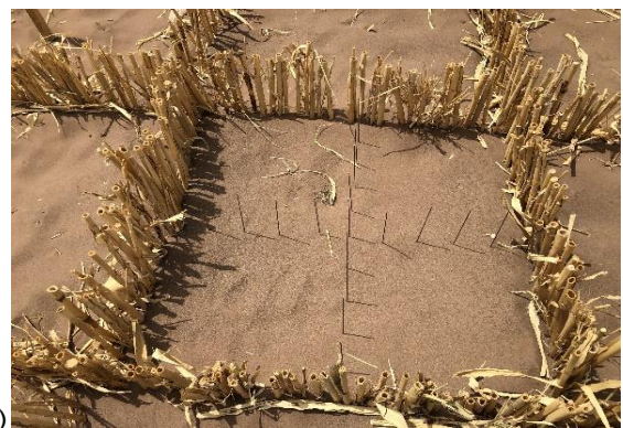
شکل ۴. نصب پیکه‌های فلزی جهت بررسی منحنی مقعر (پروفیل طولی) در یک سلول بادشکن (الف) و در یک سلول فرضی بر روی تپه شاهد (ب)
