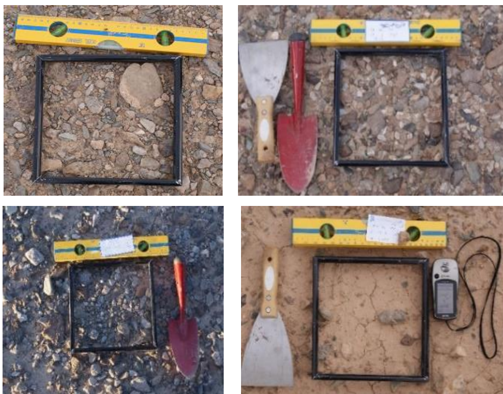
شکل ۲. نحوه پلات گذاری در صحرا برای برآورد درصد پوشش سنگفرش بیابانی
