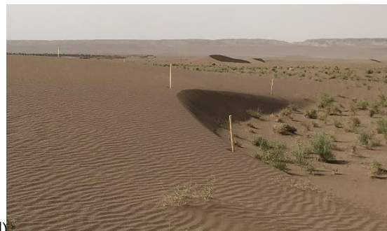
شکل ۳. نصب پیکه‌های چوبی جهت اندازه‌گیری ضریب اثر تثبیت‌کنندگی در تپه شاهد (الف) و در تپه پوشیده شده به وسیله بادشکن گیاه نی (ب)
