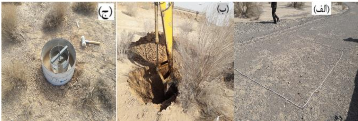
شکل ۲. تصاویر وضعیت عرصه مورد مطالعه (الف)، حفر نیم‌رخ و اندازه‌گیری عمق ریشه‌دوانی تاغ (ب) و اندازه‌گیری نفوذپذیری خاک (ج)
