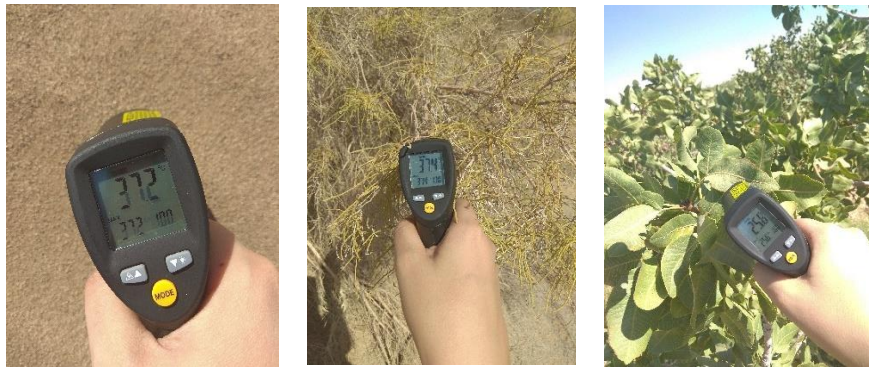
شکل ۲. تصاویری از اندازه‌گیری زمینی دمای سطح زمین با استفاده از دماسنج رقومی با دقت \pm 1/5^{\circ}\text{C}
