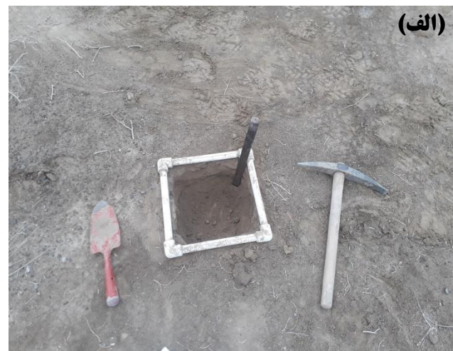
شکل ۲. نمونه‌برداری از خاک منطقه مطالعاتی، (الف) ابعاد و عمق نمونه‌ای از خاک (بهمن ۱۳۹۸)، (ب) نمایی از تعداد نمونه خاک‌های برداشت‌شده در هر تکرار (بهمن ۱۳۹۸)
